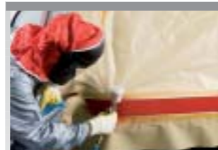
19. Klarlack in der Randzone weich auslaufen lassen. Mit Permacron® Speed Blender 1036 plus innerhalb der geschliffenen Fläche beilackieren.
